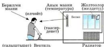
47-сүрөт. Бөлмөдө абанын температурасын жөнгө салуунун принциби.
