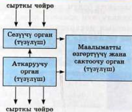
38-сүрөт. Өзү башкарылуучу системанын жөнөкөйлөтүлгөн схемасы.
