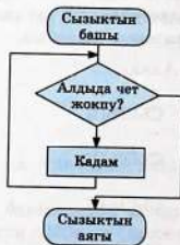
62-сүрөт. «Алкак» алгоритминин блок-схемасы.
