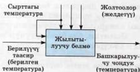
46-сүрөт. 45-сүрөттөгү көзөмөлдөөчү системанын функциялык схемасы.
