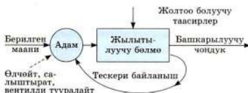
48-сүрөт. 47-сүрөттөгү системаны жөнгө салуунун функциялык схемасы.
