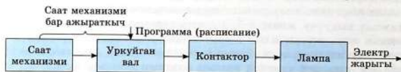
42-сүрөт. Программа менен башкарылуучу системанын функциялык схемасы (убакыт релесин колдонулган жарык берүүчү түзүлүш).
