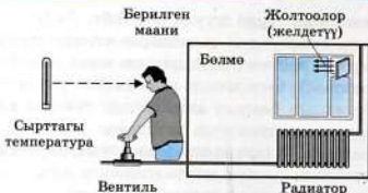
45-сүрөт. Көчөнүн температурасына жараша бөлмөдөгү температураны башкаруу.
