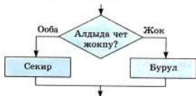
66-сүрөт. Толук бутактануунун блок-схемасы.
