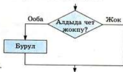
67-сүрөт. Толук эмес бутактануунун блок-схемасы.
