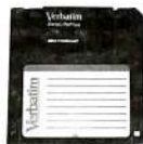
92-сүрөт. Диаметри 3,5 дюйм ийилчээк дискета.
