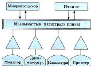
85-сүрөт. Персоналдык компьютердин структурасы (үч бурчтуктар менен контроллерлер көрсөтүлгөн).
