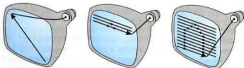
129-сүрөт. Электрон-нур түтүгүндө растрдык сүрөттөлүштү алуу.
