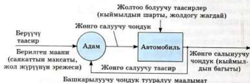
49-сүрөт. Автомобилди башкаруу – жөнгө салуунун туюк контуру.
